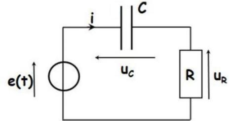
1. La tension aux bornes de la résistance est donnée par  $u_R(t) = Ri(t) = RI \cos(\omega t)$ . La tension aux bornes du condensateur est liée à l'intensité par la relation  $Cu'_C(t) = i(t) = I \cos(\omega t) \Leftrightarrow u'_C(t) = \frac{I}{C} \cos(\omega t)$ . Donc en intégrant cette égalité,  $u_C(t) = \frac{I}{C\omega} \sin(\omega t)$ . Les tensions en séries s'ajoutent donc
